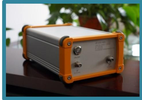
本上下变频盒子集成了一个高性能双平衡混频器、一个具卓越相位噪声的内置本振、一个保证极低谐波/杂散的无源四倍频/功率放大组件、以及射频和中频滤波器等，在一个覆盖全球毫米波几乎所有5G频段的**18-50 GHz**宽带范围内提供优异的变频性能。本变频盒具双向变频功能，通过一个随盒提供的本振控制小软件工程师们可以很容易地在电脑上设定功率预优化的本振，从而快速完成各种毫米波频率变换任务。
